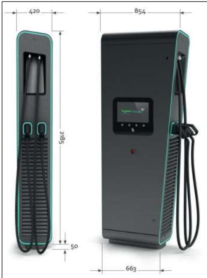
Figuur 1: Afmetingen (in mm.) HYC 150
